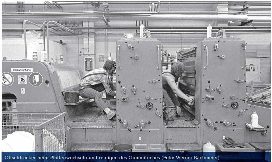
Offsetdrucker beim Plattenwechseln und reinigen des Gummituches (Foto: Werner Bachmeier)
