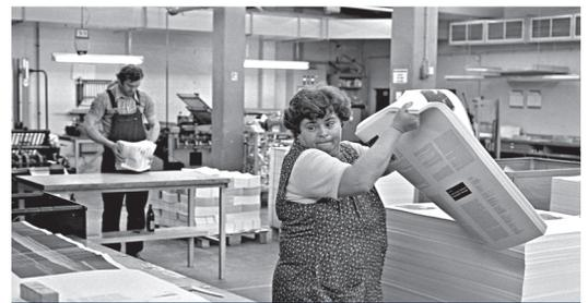
Aufsetzen der Druckbogen an die Falzmaschine
