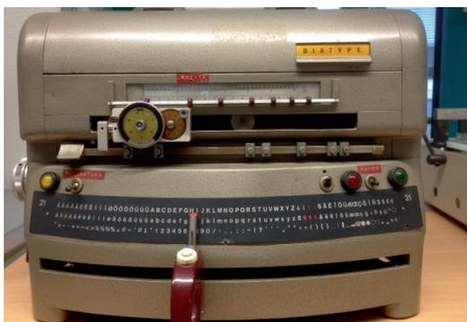
Beispielhaft sei das Diatype-Gerät genannt. Die Arbeit damit forderte eine wesentlich genauere Arbeitsplanung als bisher. Millimetergenau musste im Vorhinein berechnet werden, wie Tabellen zu setzen waren. Dafür musste ein entsprechender Fahrplan erstellt werden. Nach und nach kamen Satzanlagen auf den
